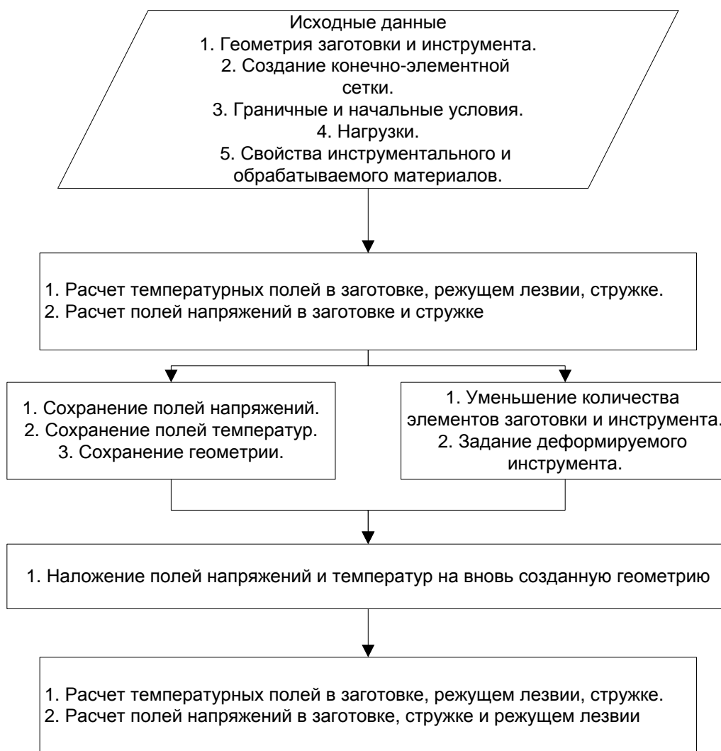
Рисунок 2.8 – Укрупненный алгоритм расчета напряжений и температур в лезвии при резании с переменной толщиной среза
